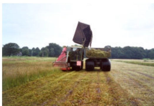
Figuur 12. Overhevelen van maaisel bij maai- en opraapcombinatie op ballonbanden
