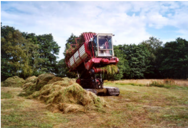
Figuur 8. Zelfrijdende opraapmachine (eigen aandrijving; methode 2b), tijdens het lossen. De laadbak kan enkele meters omhoog bewegen om over te hevelen naar ander materieel voor bijvoorbeeld tussentransport
