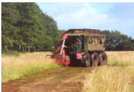
Figuur 11. Maaien met maai- en opraapcombinatie op ballonbanden
