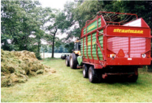
Figuur 13. Trekker en opraapwagen met aangepaste banden.
