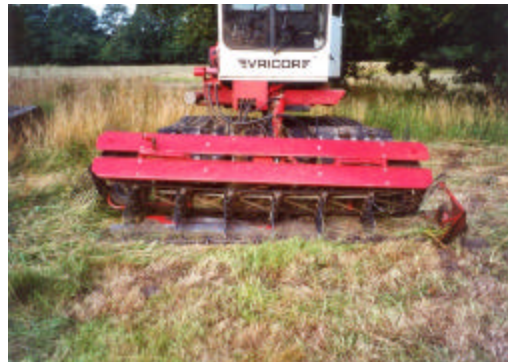
Figuur 6. Vooraanzicht van maaimachine. De bandhooier boven de maai balk brengt het maaisel direct op een wiers
