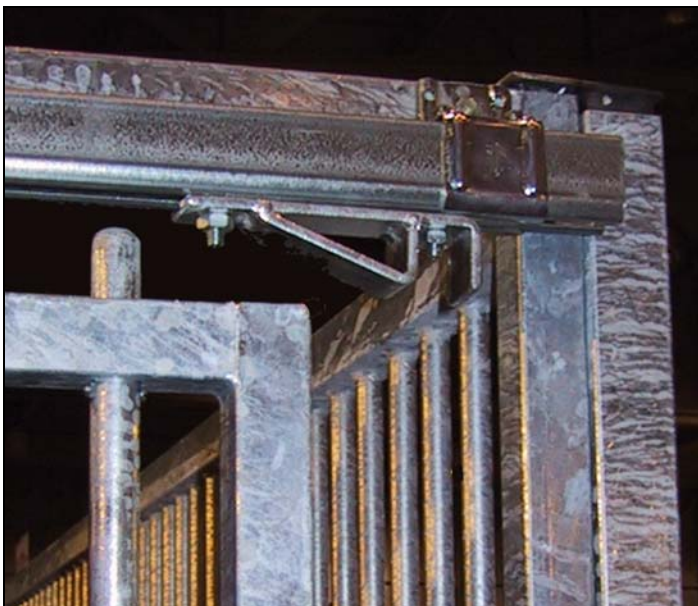
Figuur 23 Grendelsysteem voor schuifdeuren
