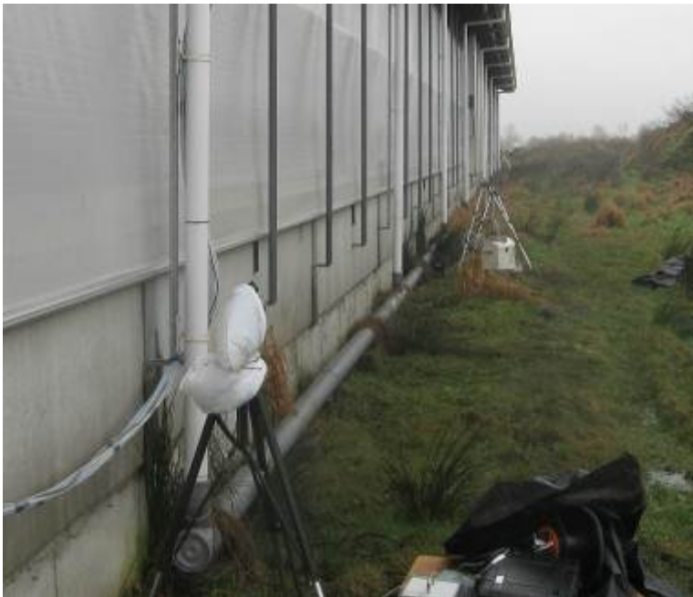
Opstelling laser buiten (de plastic zak over de laser is ter bescherming tegen vocht)
