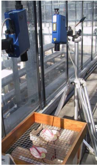
Foto 2 - Opstelling met Heimann IR sensoren om opwarmingssnelheid te meten.
