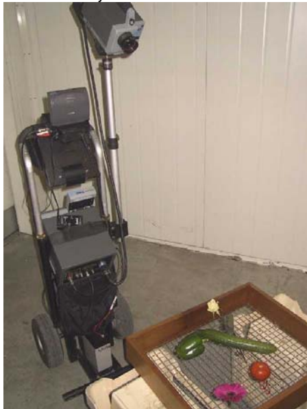
Foto 3. Opstelling voor thermografie om snelheid van opwarming te meten.
