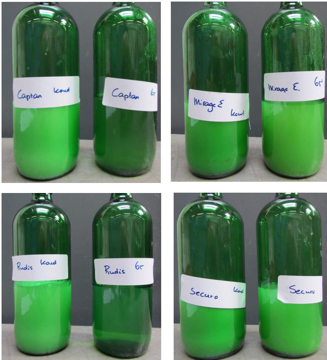
Foto 5. Oplossingen met Brabant Captan of Rudis laten een kleurloze vloeistof zien na negen keer verhitten.
