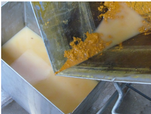
Foto 3. Ondanks continu roeren ontstond residu op de bodem van het bad na 1x verhitten (30 minuten 65°C)
