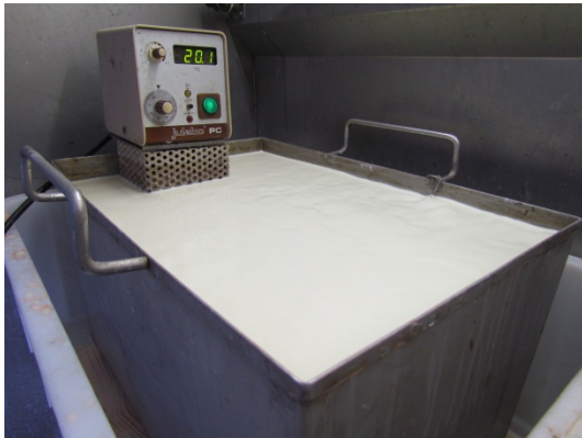
Foto 2. Rechts het dompelbad na 1x verhitten (30 minuten 65°C) in vergelijking met het normaal koud (ca. 17°C) bad links.
