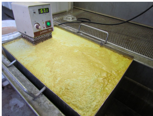
Foto 2. Rechts het dompelbad na 1x verhitten (30 minuten 65°C) in vergelijking met het normaal koud (ca. 17°C) bad links.
