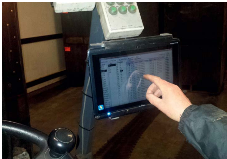
Het aantal kisten per cel wordt ingevoerd op de tablet op de heftruck
