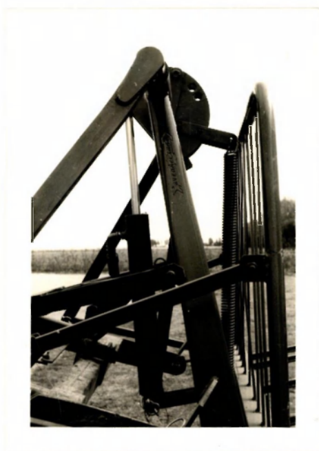
Het bevestigingspunt van de veren is verder omhoog gebracht (meer voorspanning) en verder naar buiten (8 cm) gebracht. De af te leggen weg wordt hierdoor vergroot.
