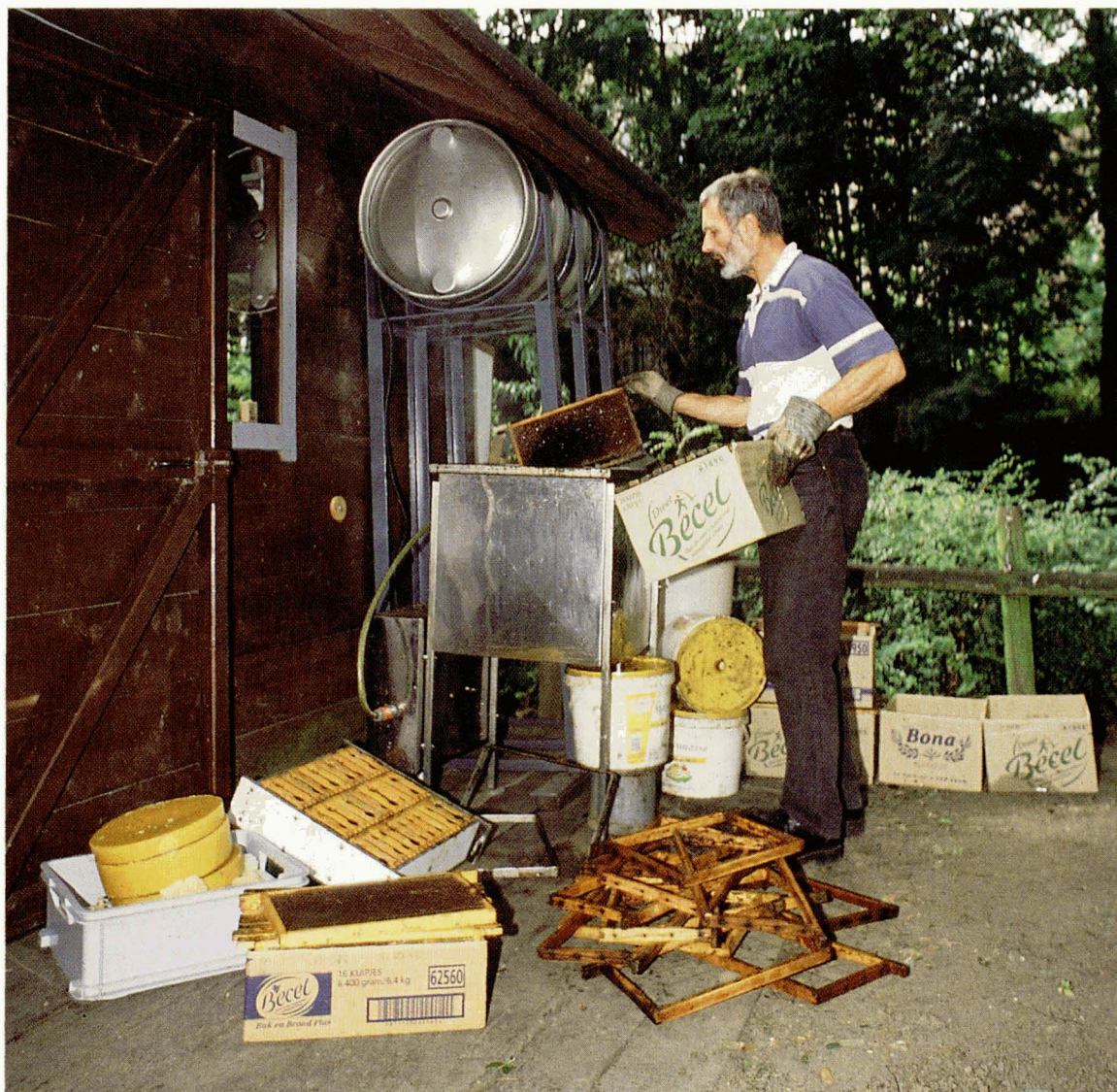
De stoomwassmelter biedt vele voordelen. Zoals: direct en op ieder moment inzetbaar (mits er stromend water en elektriciteit is), behoud van de bedrading in de raampjes, schone ontsmette was en raampjes met (uitzondering van AVB) en relatief lage stroomkosten. (Foto: P. Elshout).
