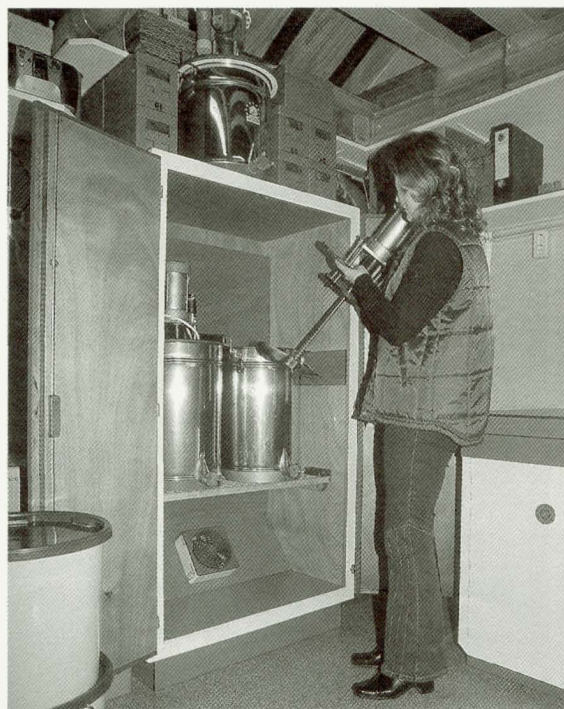
Zelfgebouwde roerinstallatie in een warmtekast, hygiënisch en doeltreffend.
