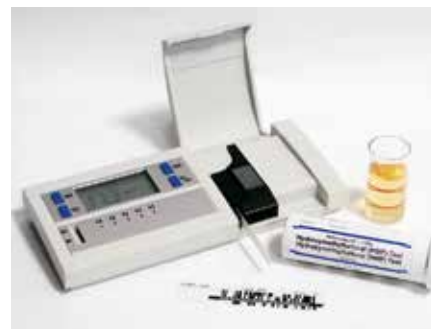
Figuur 1: Analyse van hydroxymethylfurfural. Hoeveelheid HMF wordt in honing bepaald met behulp van een teststrip. Verkleuring van de teststrip onder invloed van HMF in honing kan worden bepaald met behulp van een uitleesapparaat (RQflex).
