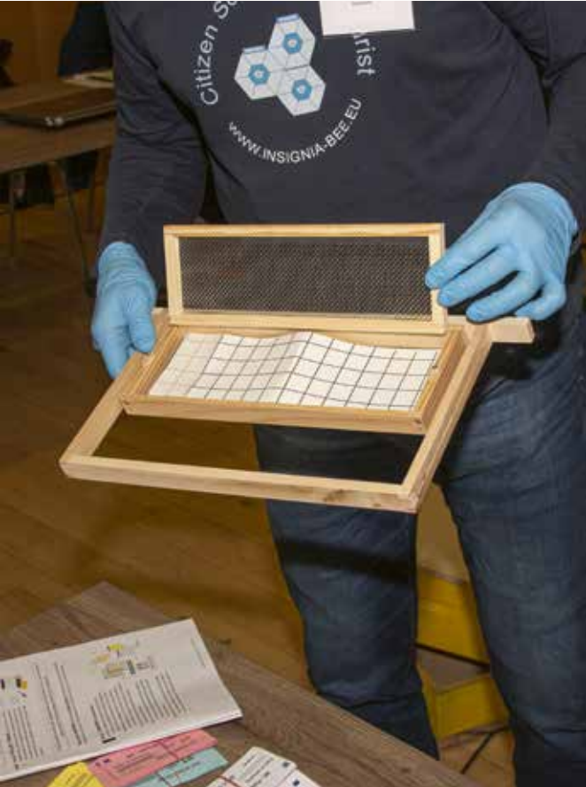
4. Kleefstrip bevestigd in API-trap met gaas eromheen.
