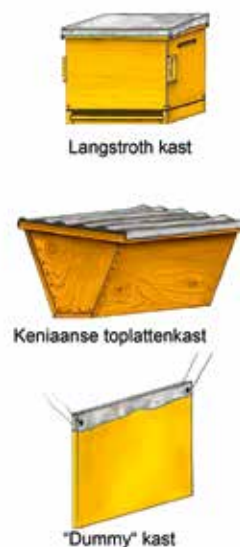
Figuur 1. Ontwerp van bijenkastomheining met ofwel Keniaanse toplattenkasten (4 boerderijen) ofwel Langstrothkasten (22 boerderijen). De kasten zijn aan elkaar verbonden met ijzerdraad en worden om de 10 m afgewisseld met een valse ('dummy') kast om kosten te besparen. Wanneer een olifant de omheining door contact in beweging brengt, schommelen de kasten en worden de bijen verstoord. Bron: King e.a. 2024.
