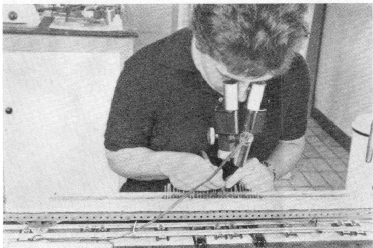
Afb. 7. Van meccano onderdelen is een „wagentje” geconstrueerd, dat op rails van een speelgoedtreintje loopt. De onderzoektijd is hierdoor vele malen korter geworden.
