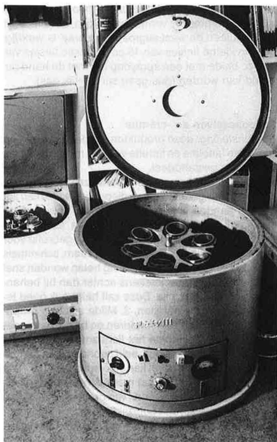
Fig. 2. Een centrifugeerapparaat met zes stalen cilinders waarin ruwe propolis wordt gedaan die in 70% ethyl alcohol is opgelost. Met een snelheid van ca. 3.000 omwentelingen per minuut wordt het propolisextract gescheiden van vuil, was en een gedeelte van de harsen. Er blijft een stroperige vloeistof over waarin zich 40% propolis bevindt.
